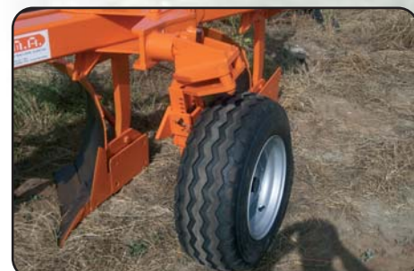
Ruota combinata lavoro e circolazione stradale Combined wheel for working and transportation Kombinad Arbeit und Straßenverkehr mit horizontalem Pflug
