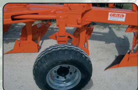
Ruota a pendolo, posizionamento centrale Reversible depth wheel, in the middle plough Pendelrad mittlere Position
