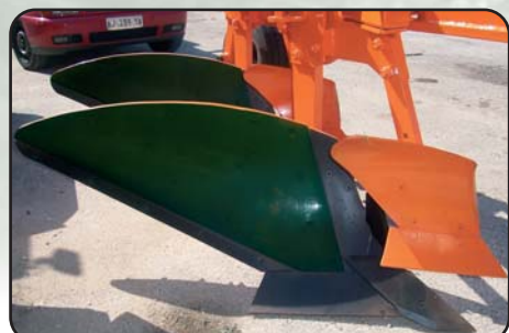
Versoio in polietilene con bande antiusura Polyethylene mouldboard with non-wear steel protections Streifblech aus Polyethylen mit Anti-Verschleisschutz
