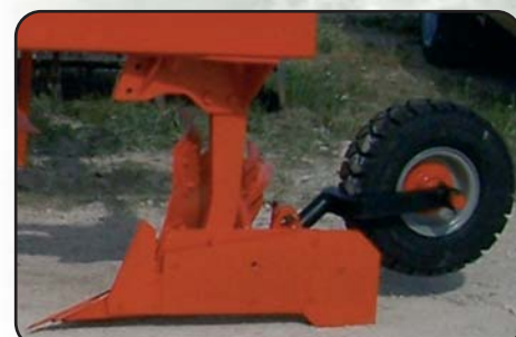
Ruota di circolazione stradale con aratro in verticale Road transportation wheel, plough on vertical Straßenverkehrsrads mit vertikalem Pflug
